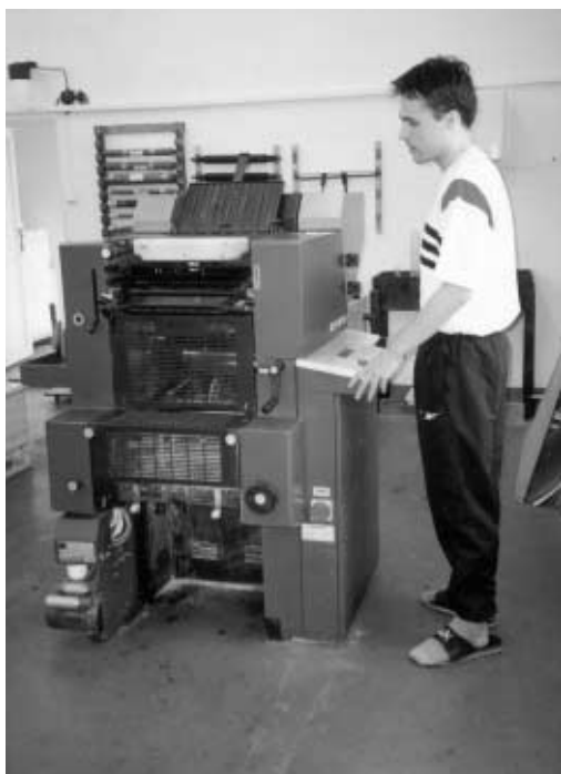
dvoubarvový ofsetový tiskový stroj Quickmaster 46-2 Heidelberg v provozní tiskové laboratoři katedry polygrafie a fotofyziky
