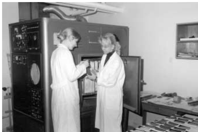
lakařská zkušebna - hodnocení vzorků po expozici UV-zářením
