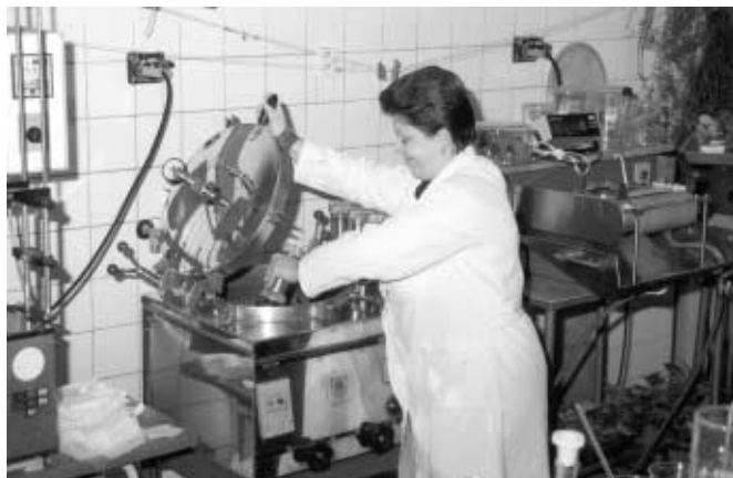
barvicí aparát CALBOT pro barvení různých typů textilních materiálů
