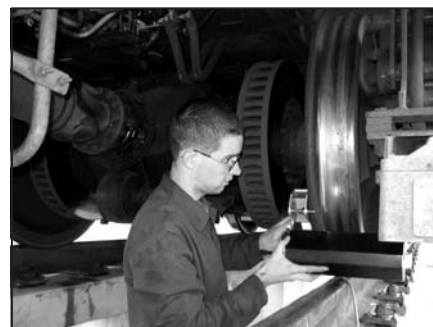
Aleš Hába při měření jízdních obrysů kol dvojkolí jednotky 680 001
