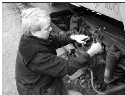
instalace měřicí techniky na vozidlo 680 001 před vysokorychlostními zkouškami
